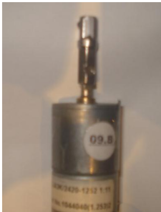
Figura 69: Peã de conexão entre o eixo do motor e as ferramentas, já encaixada no eixo do motor.
