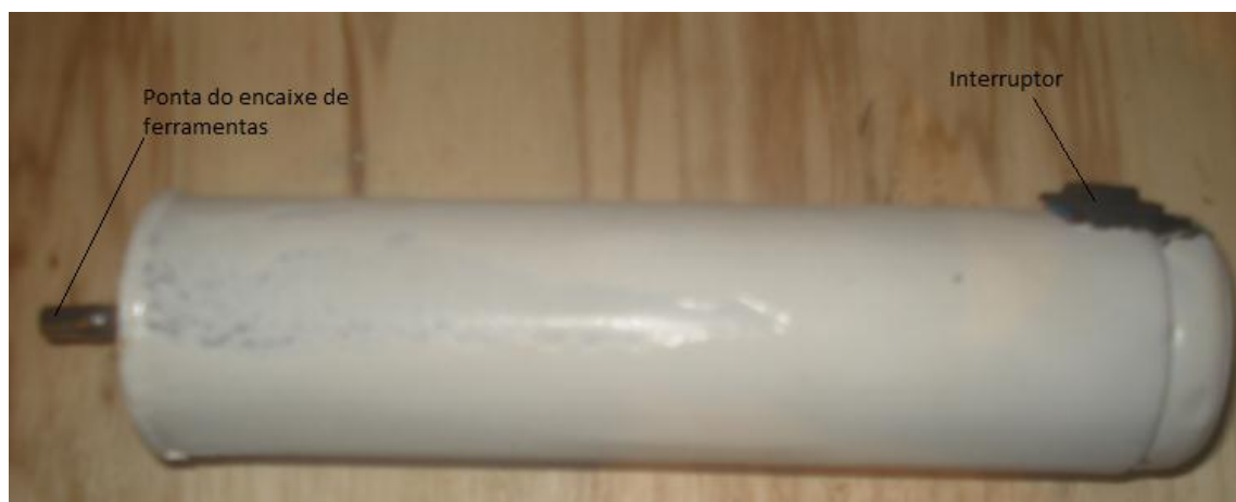
Figura 84: Carçaça com motor, suporte e baterias já encaixados.
